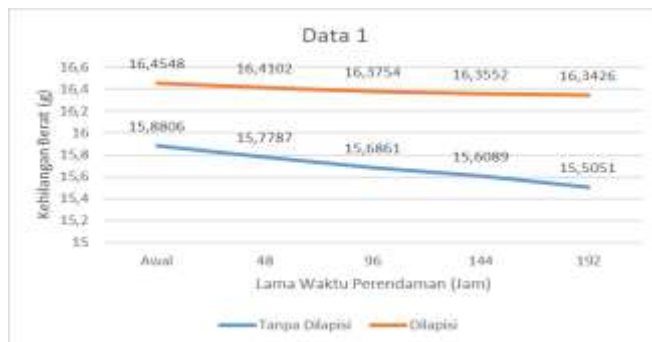
Gambar 7. Perbandingan kehilangan berat antara logam besi MS yang dilapisi dengan yang tidak dilapisi
