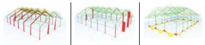
Gambar 5. Output Gaya Dalam (a) Aksial Diagram (b) Shear Diagram (c) moment diagram
